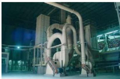
granuladores, onde é pulverizada água (até atingir uma umidade entre 9 a 10 %), a fim de se obter uma granulométrica adequada ao processo de conformação (prensagem).
