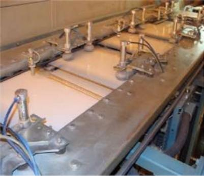
Após a classificação realizada por classes de qualidade, as placas passam por modernos e precisos sensores óticos que em quatro pontos realizam as medições das placas com extrema velocidade e separam em bitolas.
